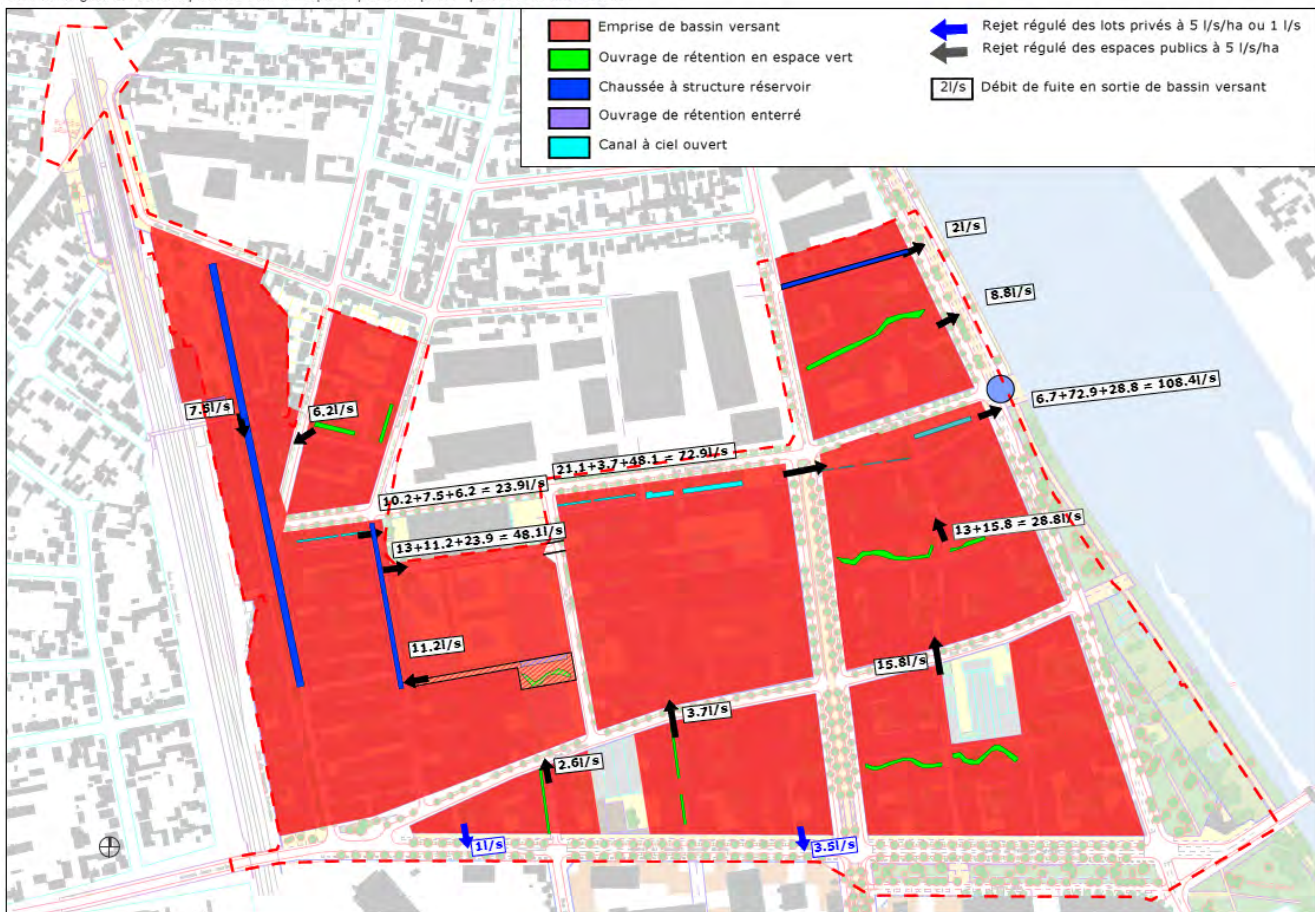
Schéma de gestion des eaux pluviales dans les espaces publics et privés - plan des bassins versants
