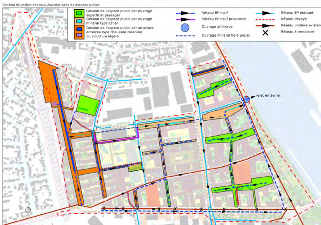
Fig. 76. Plan des ouvrages de rétention projetés dans les espaces publics. Source : MAGEO
