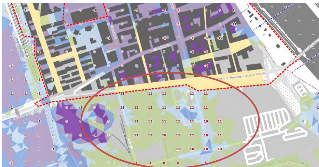
Fig. 96. Surélévation calculée à l'amont de la rue Salvador Allende sur la ZAC Seine Gare Vitry en l'absence de mesures compensatoires
